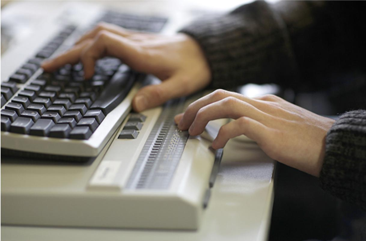
Abbildung 3: Blinde Menschen verwenden bei der Arbeit an einem Computer meist eine Braillezeile, die sie in Verbindung mit der Tastatur nutzen. (Bild: DBSV/A. Friese)
